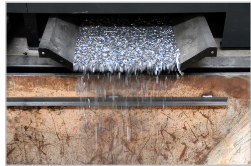
Chip extraction Detalle extracción de viruta
