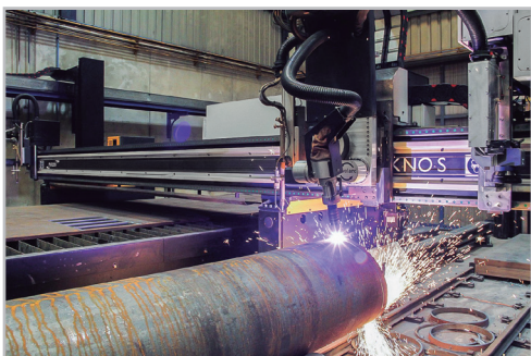
Tube & pipe plasma cutting Corte por plasma de tubos y perfiles
